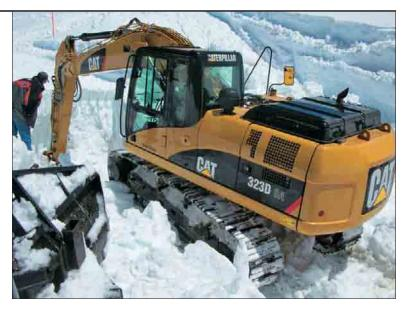
**Carro.** Il carro del 323D SA ha la stessa componentistica di quello del Cat 325D. Rappresenta la migliore soluzione quando si ha la necessità della massima stabilità e robustezza del carro, nella sagoma di 2500 mm.
