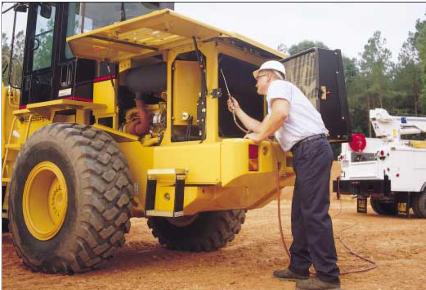
**Facilità d'accesso.** Il cofano motore, con apertura ad ali di gabbiano assistita da cilindri pneumatici, offrono un'eccezionale accessibilità ai principali componenti del motore e della trasmissione. Tutti i filtri ed i punti di servizio sono a portata di mano.
